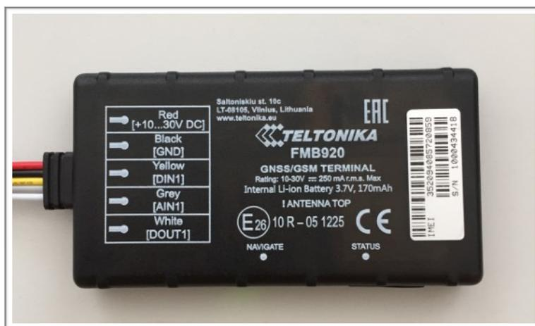
Figura 03. Cavi di connessione.
